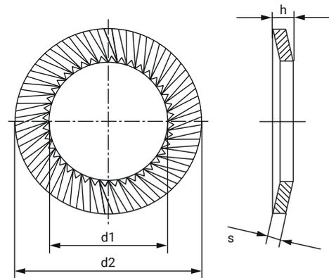
La arandela AET está especialmente diseñada para el montaje en tornillos donde no puede sobresalir la arandela.
