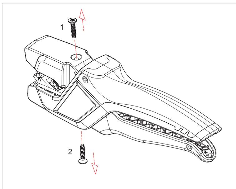
Desmontaje de los bloques de cuchillas
