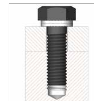
Tornillo hexagonal asegurado en un agujero ciego
