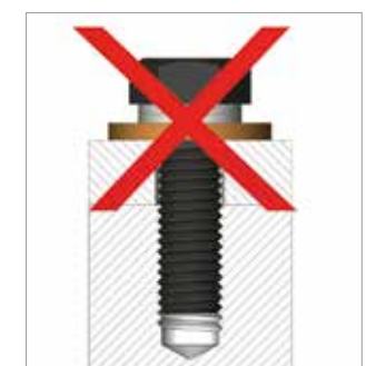
Sin función de seguridad en combinación con arandelas que giran libremente
