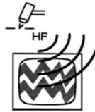
• La alta frecuencia (H.F.) puede interferir con la radionavegación, los servicios de seguridad, los ordenadores y, en general con los equipos de comunicación.
