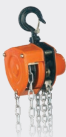
SERIE 650 POLEAS MANUALES CON LIMITADOR DE CARGA
