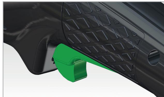
L'interrupteur doit être en position HORS. Pour enclencher la machine, placer l'interrupteur EN/HORS vers l'avant jusqu'à encliquetage. Par pression sur l'interrupteur EN/HORS l'encliquetage est libéré et la machine s'arrête.
