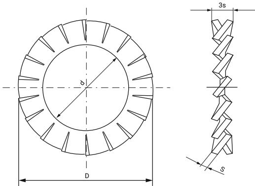
Las arandelas dentadas según norma DIN 6798 nos permiten inmovilizar elementos de unión especialmente tuercas, tornillos y pernos sujetos a vibraciones, manteniendo uniforme el par de apriete aplicado sobre el elemento de fijación en cualquier montaje mecánico, eléctrico y electrónico.
