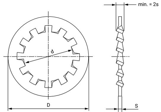
Las arandelas dentadas según norma DIN 6797 nos permiten inmovilizar elementos de unión especialmente tuercas, tornillos y pernos sujetos a vibraciones, manteniendo uniforme el par de apriete aplicado sobre el elemento de fijación en cualquier montaje mecánico, eléctrico y electrónico.
