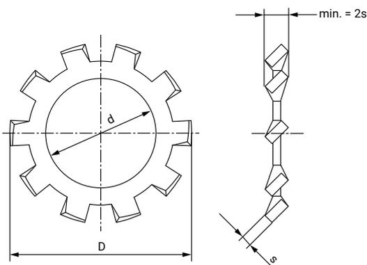
Las arandelas dentadas según norma DIN 6797 nos permiten inmovilizar elementos de unión especialmente tuercas, tornillos y pernos sujetos a vibraciones, manteniendo uniforme el par de apriete aplicado sobre el elemento de fijación en cualquier montaje mecánico, eléctrico y electrónico.
