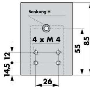
Placa para instalación horizontal del gancho
