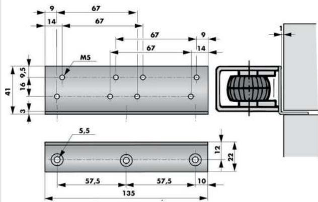
Ángulo para instalación horizontal en puertas con solape
