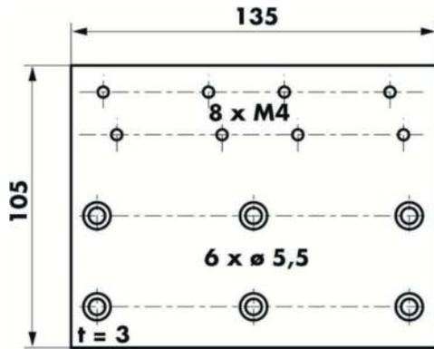
Ángulo para instalación horizontal en puertas sin solape
